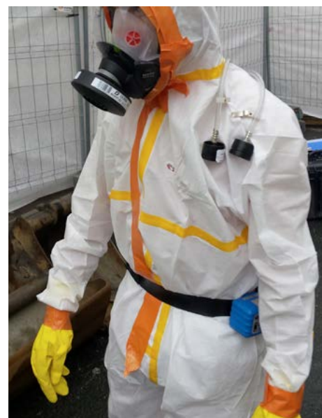
Opérateur équipé de dispositif de prélèvement individuel de fibres d'amiante
